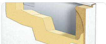
Embout de panneau en bois et isolation au polyuréthane servant de bris thermique pour éliminer le transfert de froid
