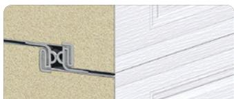
Joint InterLok<sup>MC</sup> entre les panneaux qui bloquent les infiltrations d'air pour un bris thermique remarquable
