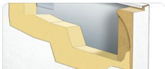
Embout de panneaux en bois et isolation au polyuréthane servant de bris thermique pour éliminer le transfert de froid
